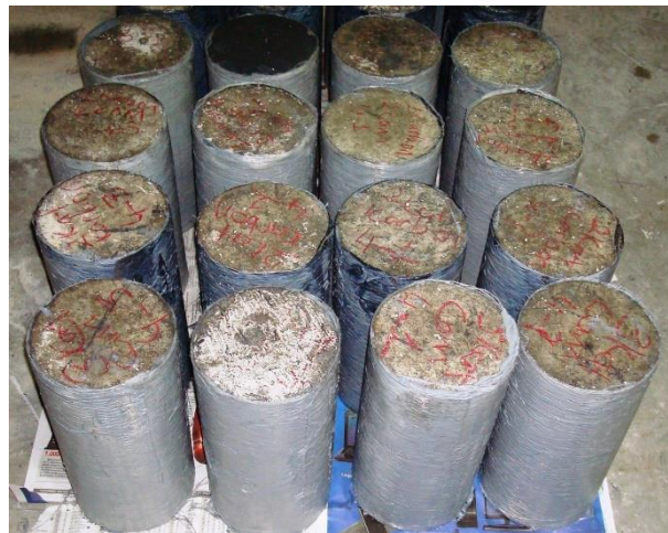
Şekil 1. FRP’ler ile güçlendirilmesi tamamlanan numuneler
